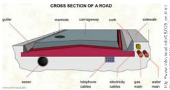
Straßenbau – Fahrbahn und Medienführung
