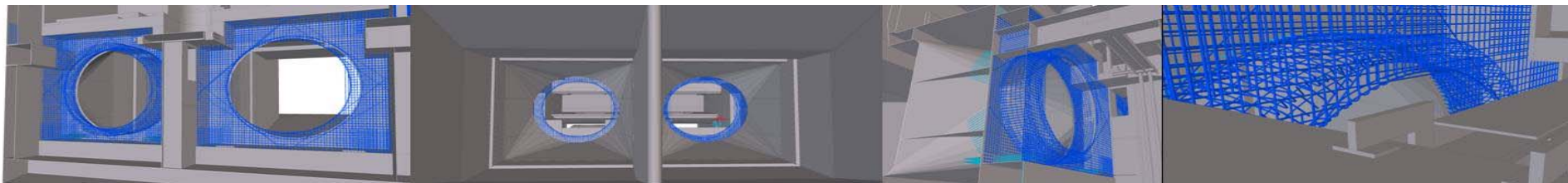
Kanal für den Turbinenzulauf und Bewehrung für den Zweitbeton
